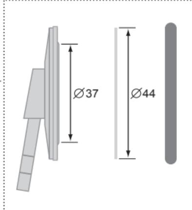
**Описание:** стетоскоп LD Prof-Plus – это фонендоскоп для прослушивания тонов Короткова, состоящий из головки в виде диафрагмы с пластиковой мембраной, соединительной трубки, бинауральных трубок и ушных наконечников.
